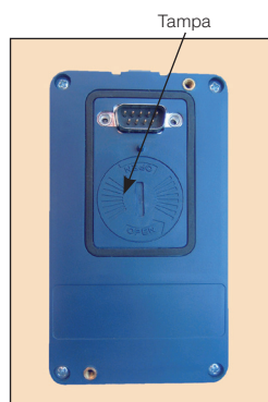
Figura 28: Localização da tampa de acesso à bateria
