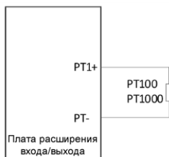
Рисунок 5-25 PT100/PT1000, измеряющий температуру через плату расширения
