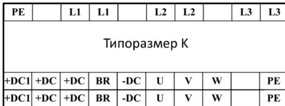
Рисунок 2-33 Силовые клеммы типоразмера K
