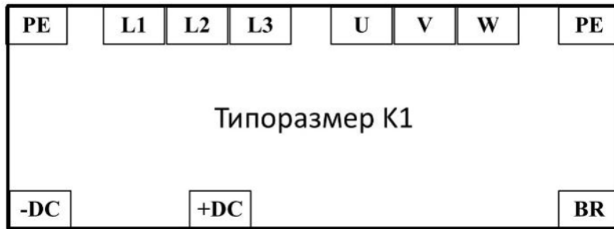
Рисунок 2-34 Силовые клеммы типоразмера K1
