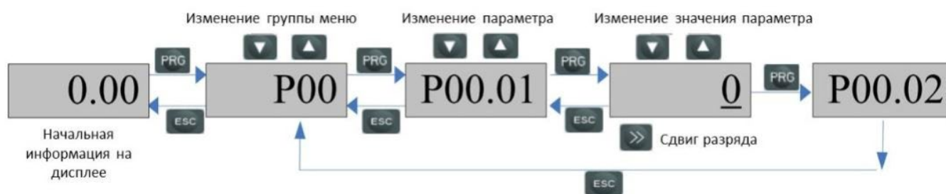
Рисунок 3-5 Просмотр параметров и процесс редактирования
