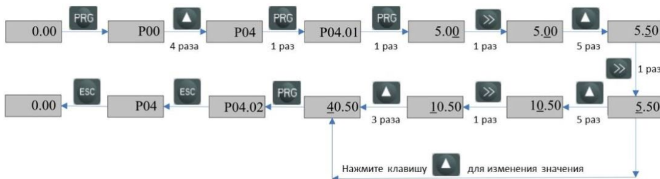
Рисунок 3-6 Последовательность редактирования параметров
