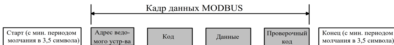
А-рисунок 1-2 Формат сообщений Modbus RTU
