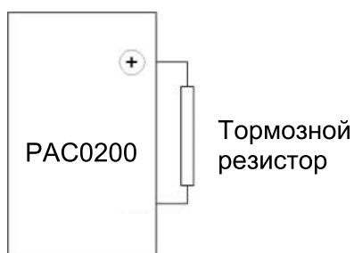
Рис. 12-3. Схема подключения тормозного резистора
