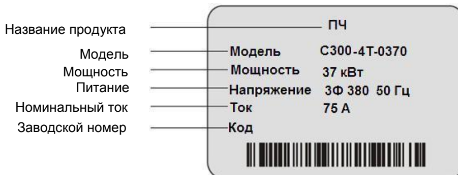
Рисунок 2-2. наклейка с характеристиками изделия
