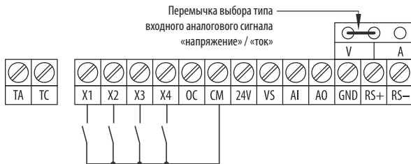
Рисунок 13 – Схема подключения сигнала типа «сухой контакт» к дискретным входам.
