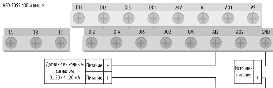
Рисунок 42 – схема подключения датчика с аналоговым выходным сигналом 0...20 / 4...20 мА (питание от внешнего источника питания 24 В).
