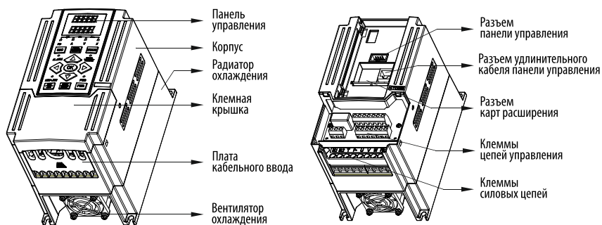
Рисунок 3 – тип корпуса 1, габариты 1, 2 (модели AFD-E040.43B и ниже)
