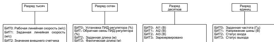
Рис. 4-14. Установка шестнадцатеричного параметра L1-02
