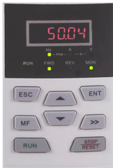
Рис. 4-7. Режим прямого изменения частоты
