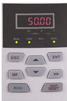
Рис. 4-3. Режим отображения параметров работы (отображение рабочей частоты – 50,00 Гц)
