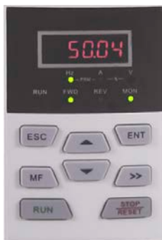
Рис. 4-7. Режим прямого изменения частоты
