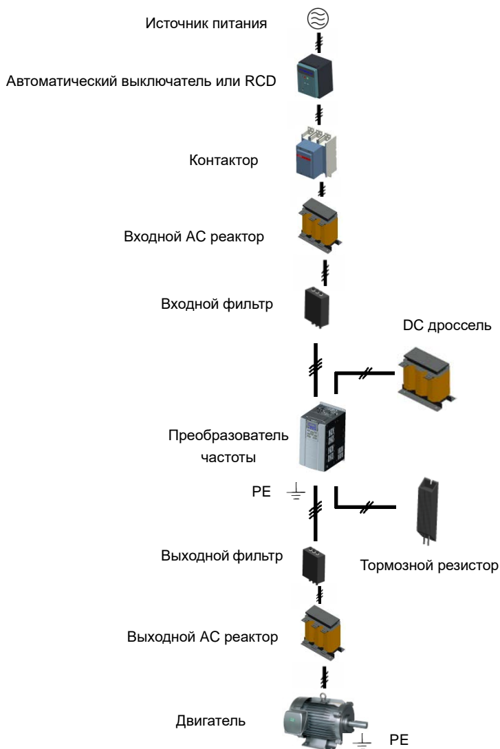
Рис.3-12 Стандартная конфигурация периферийных устройств
