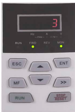
Рис. 4-10. Второй уровень отображения параметра («3» – это значение параметра b0-00)
