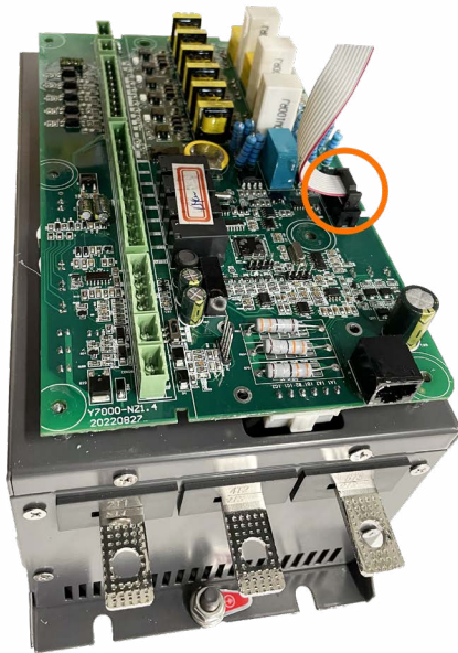
Рисунок 16 – Шлейф панели управления устройства плавного пуска
