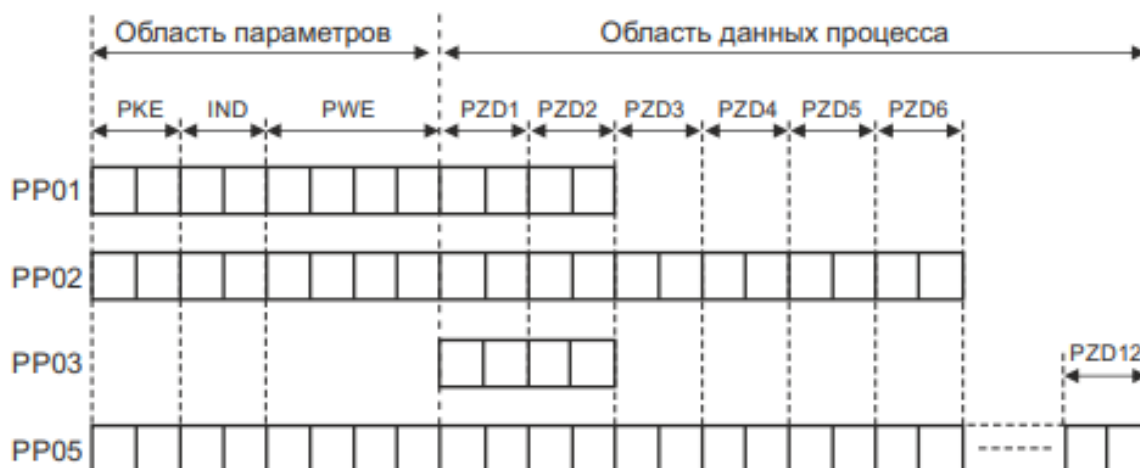
Рисунок 3 – Формат данных в структурах PPO
