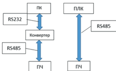
Рис. 7.1 Сетевой режим Master/Slave
