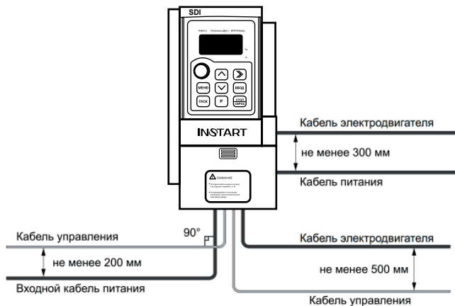
Рис. 3.6 Графическое представление расстояний между кабелями
