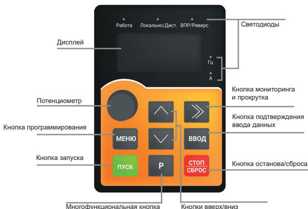
Рис. 5.1. Функции кнопок и светодиодов панели управления SDI
