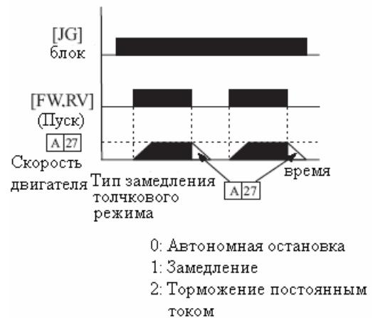
Тип используемого замедления для завершения толчкового режима двигателя выбирается программированием регистра **A27**. Параметры:
