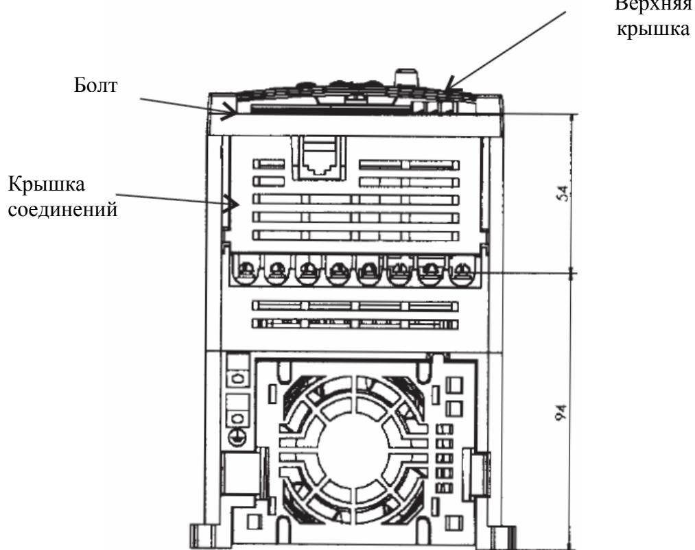
Используйте отвертку чтобы отвинтить болт с верхней панели.
