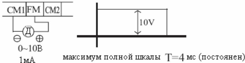
Примечание. Это специализированный индикатор, так что он не может быть использован в качестве сигнала скорости передачи данных. Точность индикатора после настройки составляет  $\pm 5\%$ . (Зависит от измерительного прибора, точность может превышать это значение).
