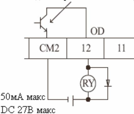
Примечание: пример цепи в таблице управляет катушкой реле. Заметьте, что использование диода для предохранения отрицательного выключающего всплеска сгенерированного катушкой от выведения из строя выходного транзистора инвертора.
