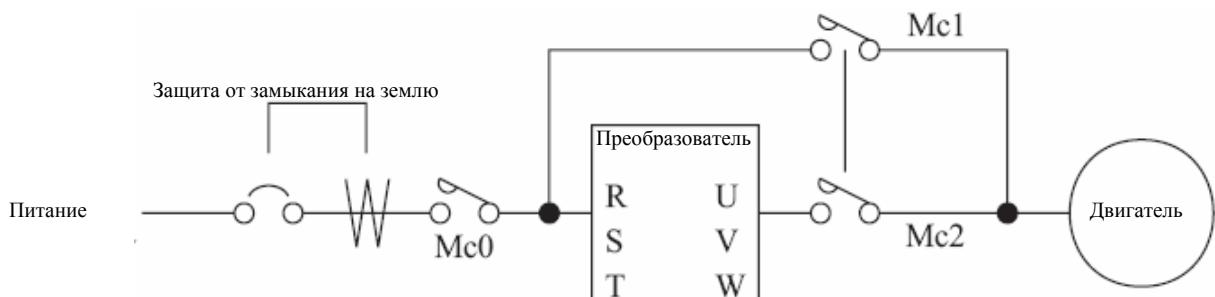
**Примечание 2.** Подключите заземление со стороны блока питания инвертора. Если расстояние между инвертором и мотором большое (10м и более), то термореле может работать неправильно из-за высокочастотного шума. К выходу инвертора подключите дроссель или используйте датчик тока.
