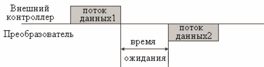
Блок данных запуска: блок данных запуска определяется по передаче данных по сигнальной линии.
