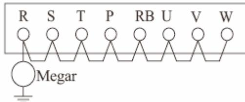
Никогда не производите проверку выходного напряжения инвертора. Преобразователь имеет разрядник для защиты от перенапряжений между блоками главной схемы и заземлением корпуса.
