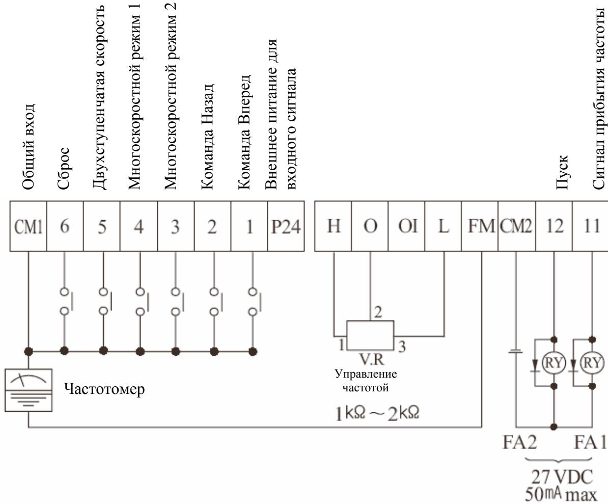
**Примечание 1.** При использовании внешнего программируемого блока убедитесь в подключении стабилизирующего диода параллельно с реле. Иначе, скачок напряжения, созданный при замыкании и размыкании реле может повредить схему программируемого блока на выходе.
