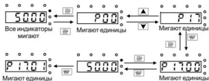
Рис.5-5. Схема контроля состояния
