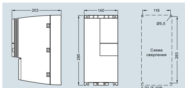
SINAMICS G120C типоразмера FSC; от 11 до 18,5кВт
