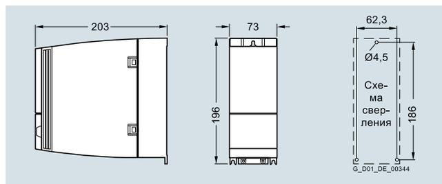
SINAMICS G120C типоразмера FSA; от 0,55 до 4,0кВт
