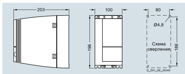
SINAMICS G120C типоразмера FSB; от 5,5 до 7,5кВт
