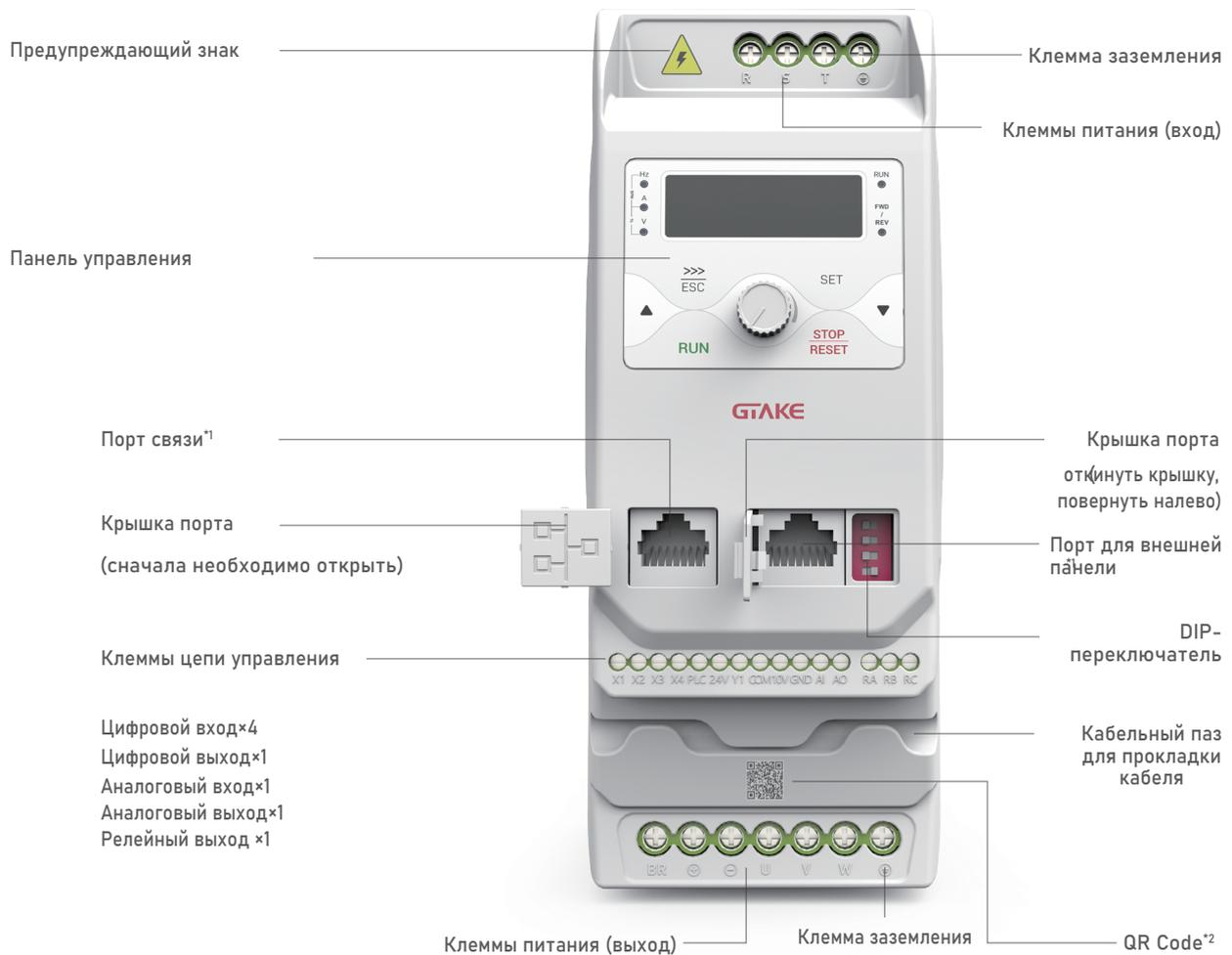
\*1: Поддерживаются два сетевых порта RS-485 и многоуровневая связь. Стандартный сетевой кабель и максимальное расстояние связи до -3 метров
