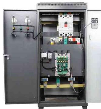
**Оф-лайн (P)** — Исполнение с шунтирующим контактором. После окончания разгона, силовые ключи УПП шунтируются внешним контактором. В этом исполнении, по окончании разгона, УПП потребляет минимум электроэнергии и выделяет минимум тепла. Отвод тепла может потребоваться только в момент пуска электродвигателя. Занимает большую площадь в шкафу.
