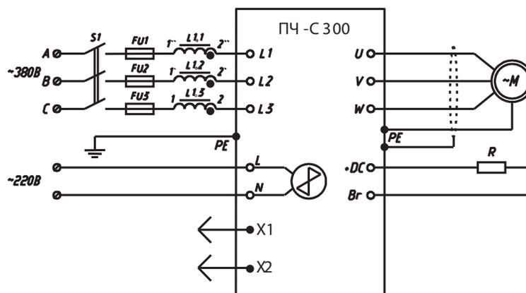
Возможность подключения тормозного резистора R реализована во всех модификациях ПЧ-С100 и ПЧ-С200; при необходимости подключения тормозного резистора к ПЧ-С300, в обозначении при заказе нужно добавить индекс Т (например, ПЧ-С300/22Т). Ввод дополнительного напряжения 220 В для питания вентилятора необходим в модификациях ПЧ-С300 от 30 кВт и выше.
