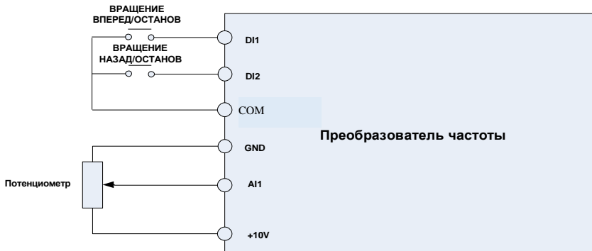
Рисунок 4. Схема подключения цепи управления
