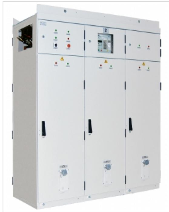
Режим работы ШПТУ-Д(Т) повторно-кратковременный с временем непрерывной работы 90+/-5 с при трёхкратной величине пусковых токов от номинального значения типоразмера ШПТУ с последующей паузой не менее 10 мин. (3 пуска подряд с временем пуска до 30 с). При меньшей величине пусковых токов время непрерывной работы ШПТУ увеличивается на величину кратности  $3I_{ном}/I_{пуск}$ .
