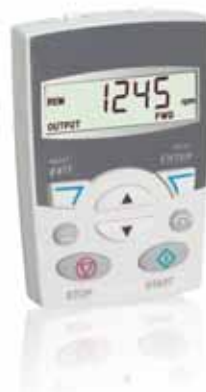
Базовая панель управления
